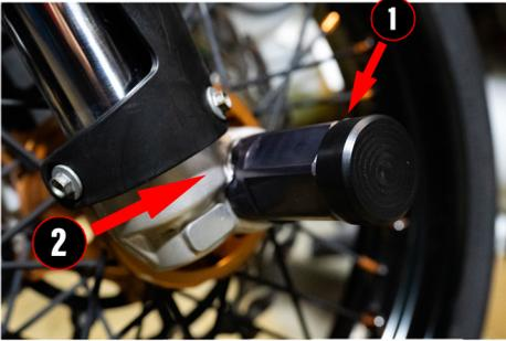
M10 Slider montieren und handfest anziehen. Sollte sich der Slider nicht mehr per Hand abdrehen lassen, ist er zu fest angezogen. Um dies zu gewährleisten, kann ein Tropfen Silikon-Öl zwischen Peg und Slider aufgetragen werden ①.
