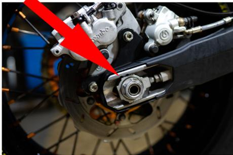
Hinterachsmutter montieren und mit vorgeschriebenen Drehmoment anziehen (Bsp. 80NM BJ 2016 EXC 500).
