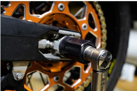
**Mutter mit 30NM (Max. 40NM) anziehen.
