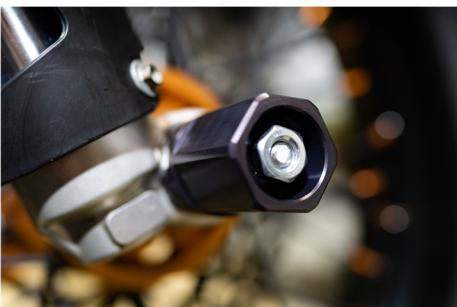
Mutter und Unterlegscheibe M10 montieren.
