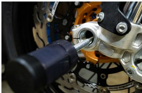
Verschlussbüchse **2** kann nun entfernt werden. Dazu kann das bereits zusammengebaute Peg benutzt werden.
