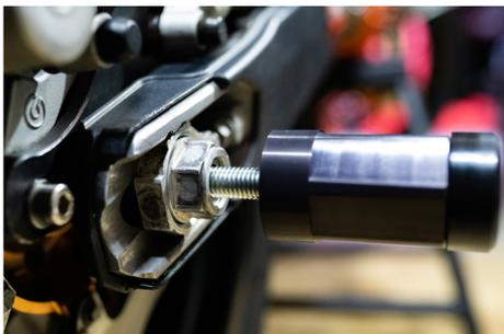
Die vormontierte Gewindestange (M12) durch das Loch in der Mutter schieben.
