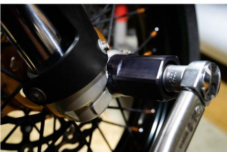
Mutter festziehen mit 20 NM ( MAX 30 NM)
