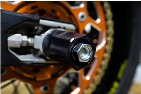
**Mutter und Unterlegscheibe M12 montieren.**
