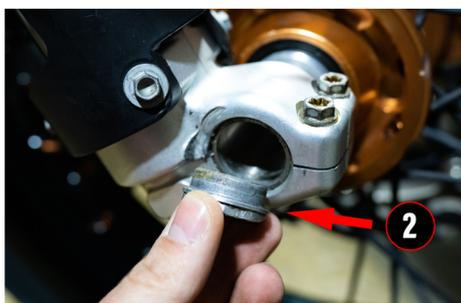
Dabei ist es wichtig weder die Gewindestange noch die Achse zu beschädigen. Sollte die Hülse fest sitzen, können die 2 Schrauben an dem Gabelfuß gelöst werden. Wärme oder drehen der Hülse kann auch helfen.
